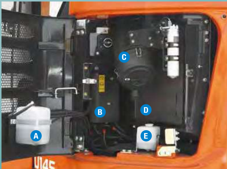
A. Kühlmittelausgleichsbehälter D. Klimaanlage B. Relaiskasten E. Scheibenwaschbehälter C. Luftfilter
